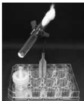
図3 鉄と硫黄の加熱実験
