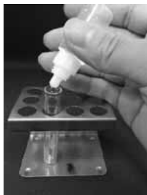
図7 点眼瓶による塩酸の滴下
